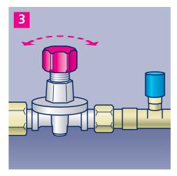
Stellen Sie den vorgeschriebenen Ausgangsdruck durch Drehen der Regulierschraube am Druckregler ein:
