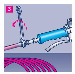
Verbinden Sie den Brenner mit dem Gasschlauch. Verwenden Sie immer hochwertige, fertig montierte Gasschläuche nach Norm EN ISO 3821. Ziehen Sie die Sechskantmutter des Schlauchs mit einem Schraubenschlüssel gegen den Uhrzeigersinn fest.
