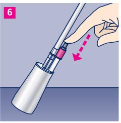
... und drücken Sie den Knopf der Piezo-Zündung, die sich an der hinteren Seite des Flammbechers befindet.
