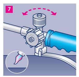
Stellen Sie die Sparflamme mit dem Drehknopf oben am Handgriffs so ein, dass sie eine Länge von 8 cm nicht überschreitet.
