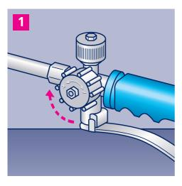
Stellen Sie sicher, dass das Hauptventil des Brenners geschlossen ist.
