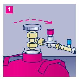
Drehen Sie den Gashahn an der Gasflasche zu.
