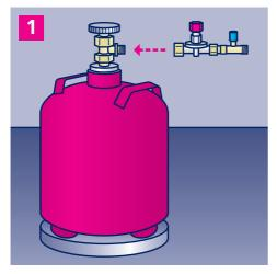
Schließen Sie den Druckregler an einer Gasflasche (Propan- oder Butangas) an.
