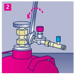
Achten Sie darauf, dass die Dichtung vorhanden ist (nicht notwendig für Regler mit POL-Anschluss), und ziehen Sie die Sechskantmutter des Druckreglers mit einem Schraubenschlüssel gegen den Uhrzeigersinn fest.
