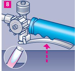
Wenn Sie den Schnellschalthebel ziehen, wird die maximale Flamme erreicht. Beim Loslassen des Schnellschalthebels wird wieder die Sparflamme eingeschaltet.
