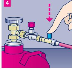
Drücken Sie den Kunststoffknopf der Schlauchbruchsicherung und warten Sie, bis der Schlauch mit Gas gefüllt ist und unter Druck steht.
