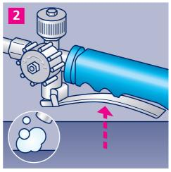
Lassen Sie das gesamte Gas im Schlauch heraus, indem Sie den Schnellschalthebel ziehen.
