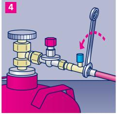
Verbinden Sie den Schlauch mit dem Druckregler. Ziehen Sie die Sechskantmutter des Schlauchs mit einem Schraubenschlüssel gegen den Uhrzeigersinn fest.
