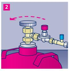
Drehen Sie den Gashahn an der Gasflasche auf.
