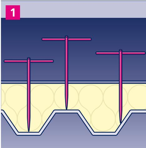
1. Über eine Stichprobe den Obergurt des Trapezblechs ermitteln und Position der Dachkonsole festlegen.
