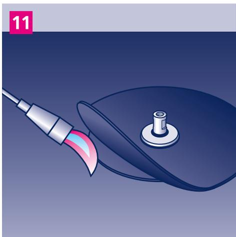
11. Den Folienflansch bzw. die beiden Bitumenflansche mit der Flächenabdichtung verbinden.
