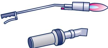
**Aufschweißbrenner** (Bitumenflansch) oder **Heißluftgerät** (Folienflansch) zum Verbinden des Flansches mit der Dachfläche
