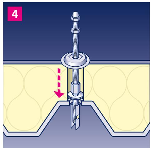
4. Den eingeklappten Kippdübel durch das Loch im Trapezblech führen.
