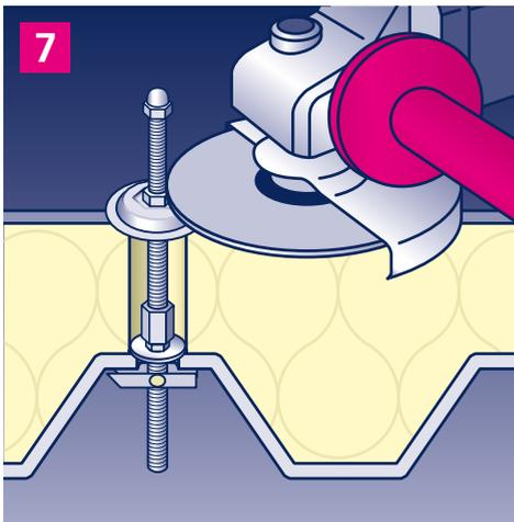
7. Herausragenden Teil der Gewindestange mit Hilfe einer Trennscheibe oder einer Metallsäge direkt über der Fixiermutter abtrennen.
