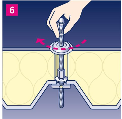
6. Fixiermutter per Hand auf der Gewindestange nach unten drehen, bis sie auf der Distanzscheibe aufliegt. Nur so fest anziehen, dass die Dachabdichtung nicht eingedrückt wird.
