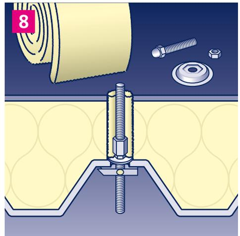
8. Fixiermutter von der Gewindestange abschrauben und die Distanzscheibe entfernen. Hohraum um die Gewindestange herum mit Stopfwohle oder Schaum (je nach Anforderung) ausfüllen.
