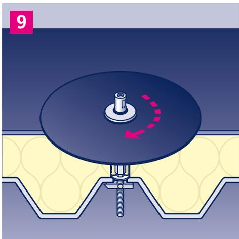
9. Dachkonsole auf die Gewindestange aufsetzen und im Uhrzeigersinn vorsichtig festdrehen, bis der Flansch auf der Dachfläche aufliegt.
