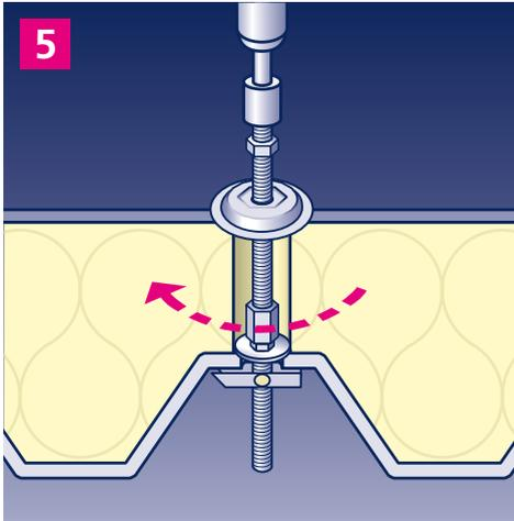
5. Gewindestange einschrauben, bis die Unterlegscheibe auf dem Trapezblech aufliegt, und festziehen.
