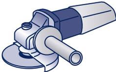
**Winkelschleifer mit Trennscheibe** zum Kürzen der Gewindestange
