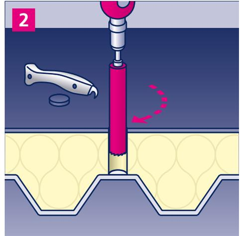
2. Dachbahn mit dem Pappmesser auftrennen und mit dem Dämmstoffbohrer (40 mm Ø) die Dämmung bis zum Blech ausschneiden. Wichtig: Trapezblech nicht verletzen!
