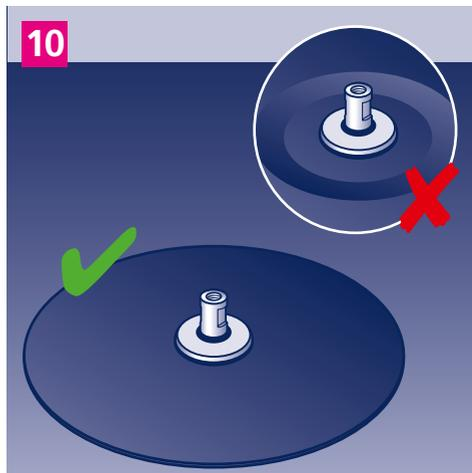
10. Achtung: Die Dachkonsole darf nur so weit verschraubt werden, dass keine Verformungen in der Dachabdichtung entstehen.
