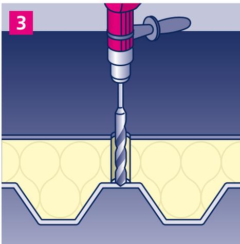
3. Konzentrisch zum Ausschnitt in der Dämmung ein Loch (Ø 25 mm) für das Einsetzen des Kippdübels bohren. Als Zentrierhilfe nutzen Sie ggf. den umgedrehten Lochschneider.
