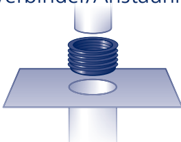
Rückstaudichtung zur sicheren Verbindung mit vorhandenen Rohren, anstelle eines Rollrings Innen-Ø 50/63/75/90/110/125/145 mm
