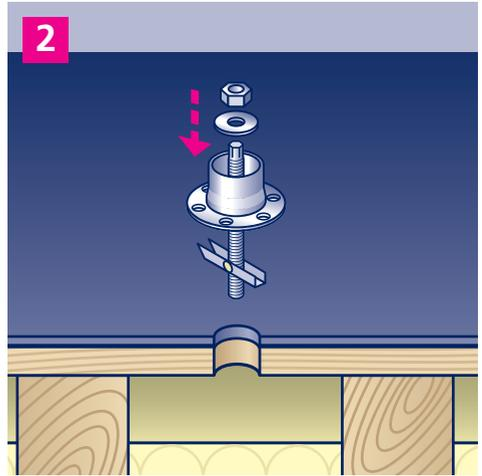
2. Kippdübel von unten durch den Konsolenadapter stecken. Von oben die Unterlegscheibe aufstecken und die Mutter aufschrauben.
