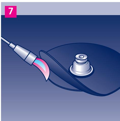
7. Den Folienflansch bzw. die beiden Bitumenflansche mit der Flächenabdichtung verbinden.
