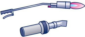
**Aufschweißbrenner** (Bitumenflansch) oder
