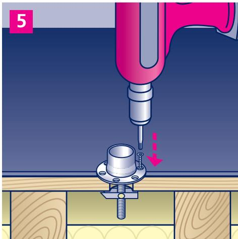
5. Mindestens eine weitere Holzschraube durch ein Loch im äußeren Rand führen und Konsolenadapter damit gegen Verdrehen sichern.
