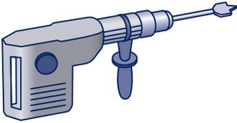
**Bohrmaschine mit Holzflachbohrer**
