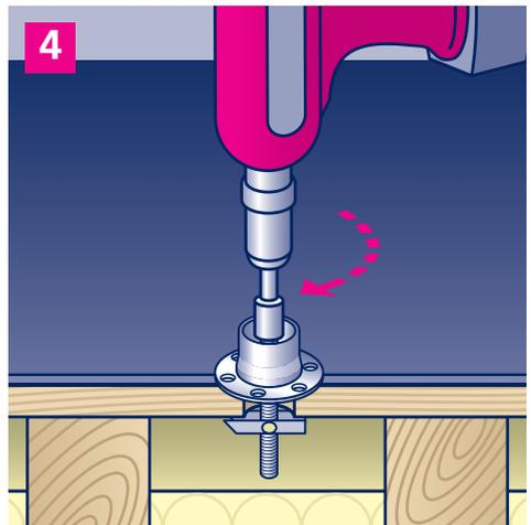
4. Die Gewindestange des Kippdübels einschrauben, bis die Unterlegscheibe aufliegt, und festziehen.
