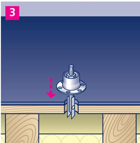
3. Den eingeklappten Kippdübel durch das Loch führen, bis das Kippelement unter der Holzschalung aufklappt.
