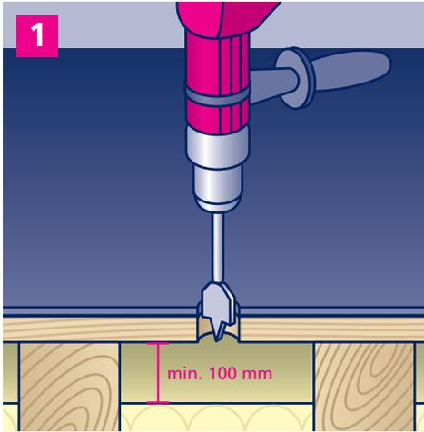
1. Position der Dachkonsole festlegen und mit einem Flachbohrer 25 mm Ø ein Loch durch Abdichtung und Holzschalung bohren.
