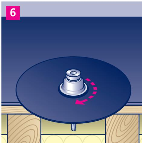
6. Dachkonsole auf das Gewinde des Konsolenadapters aufsetzen und im Uhrzeigersinn vorsichtig festdrehen, bis der Flansch der Dachkonsole auf der Dachfläche aufliegt.
